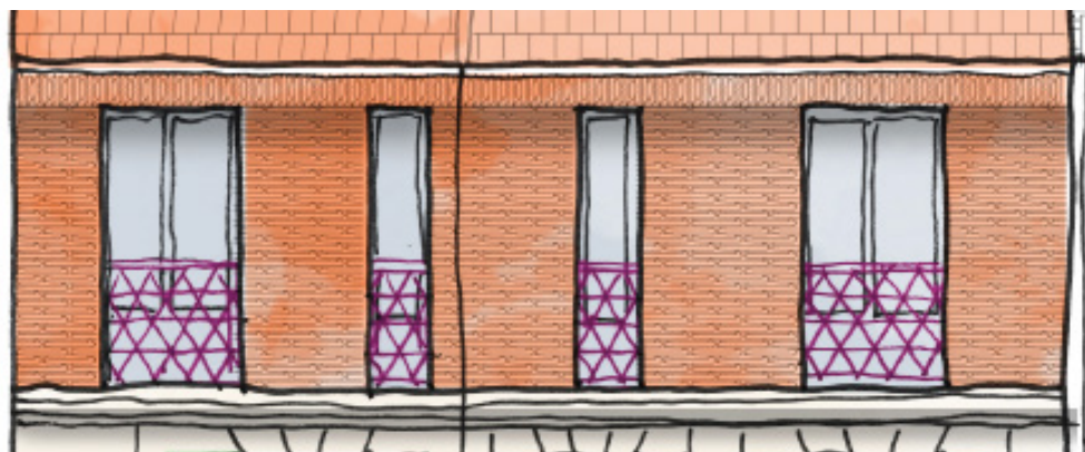
Coupe / façade de principe du parement en tuile de réemploi
